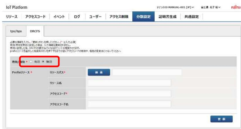
4. Prefix リソースの右側にある検索ボタンをクリックすると Prefix リソースパス検索画面が表示されます。リソースパスに drcfs と入力して検索を実行し、Prefix リソースとして割り当てるリソースパス (drcfs) を選択して確定ボタンをクリックしてください。
