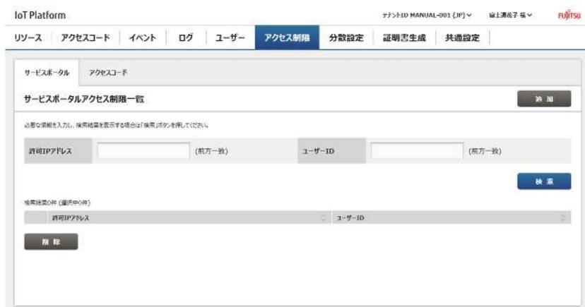
サービスポータルアクセス制限では、お客様管理のテナント内のサービスポータルへのアクセスすることのできるユーザーと許可 IP アドレスの組み合わせを登録できます。許可 IP アドレスは例えば 10.11.22.33-10.11.22.44 といった範囲で指定できます。アクセスしようとするユーザーの端末の IP アドレスが当該ユーザーの許可 IP アドレスの範囲と異なる場合、サービスポータルへのアクセスが拒否されます。
